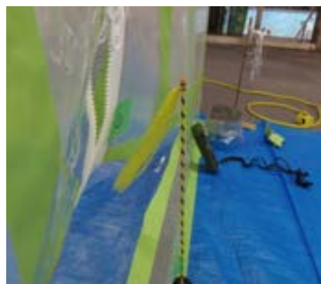
参考図4.11 吹き流しによる確認
