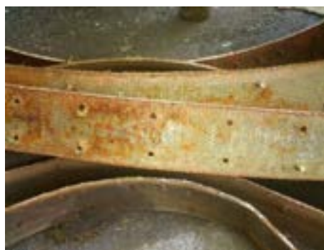
図 2-11 ウインドラスのブレーキライニング
