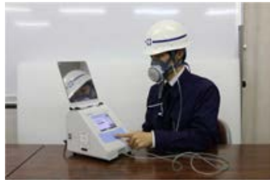
図5.2.14 マスクフィッティングテスター 使用例
