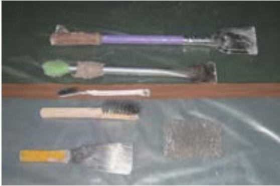
参考図 3.34 除去作業用の手工具の例
