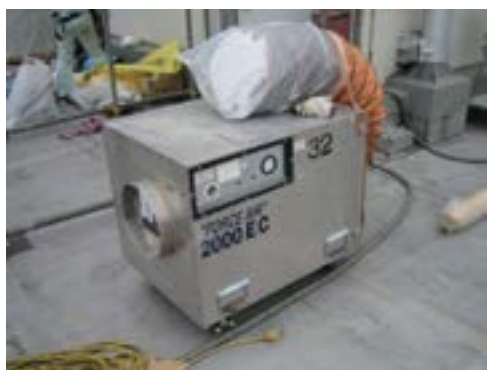
参考図 3.11 集じん・排気装置の例
