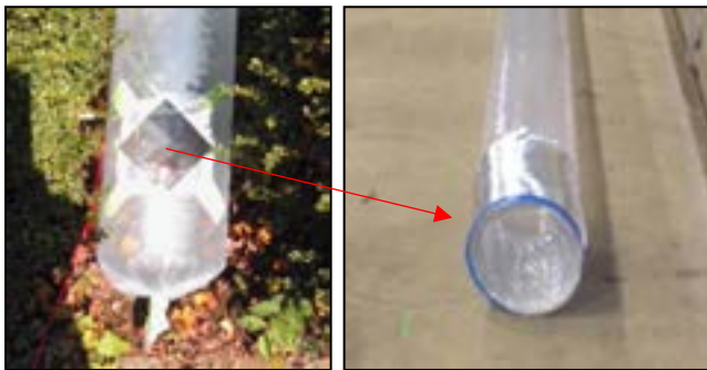
(x) (o) ビニールダクトの先端部分を環状の支え（アルミ製ダクト）を重ねて使用した例
