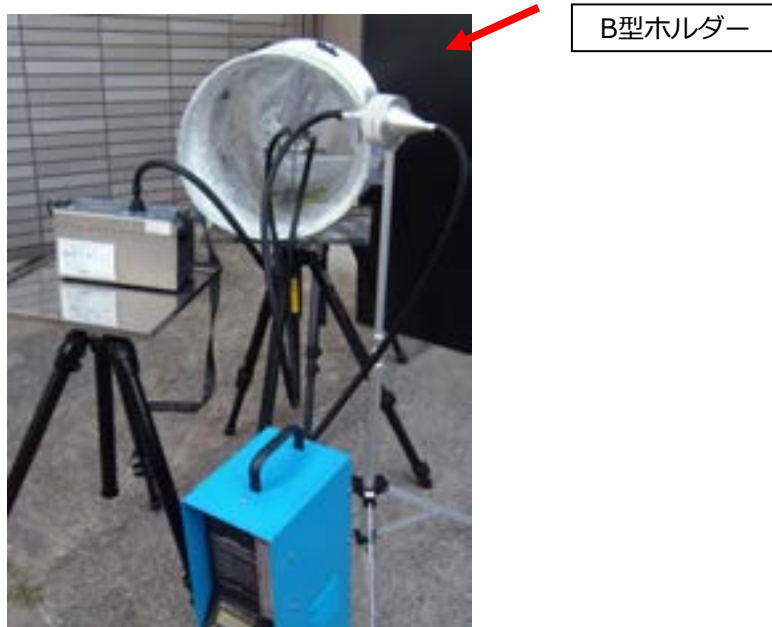
参考図 4.19 排気ダクト内からの PCM 法サンプル採取例
