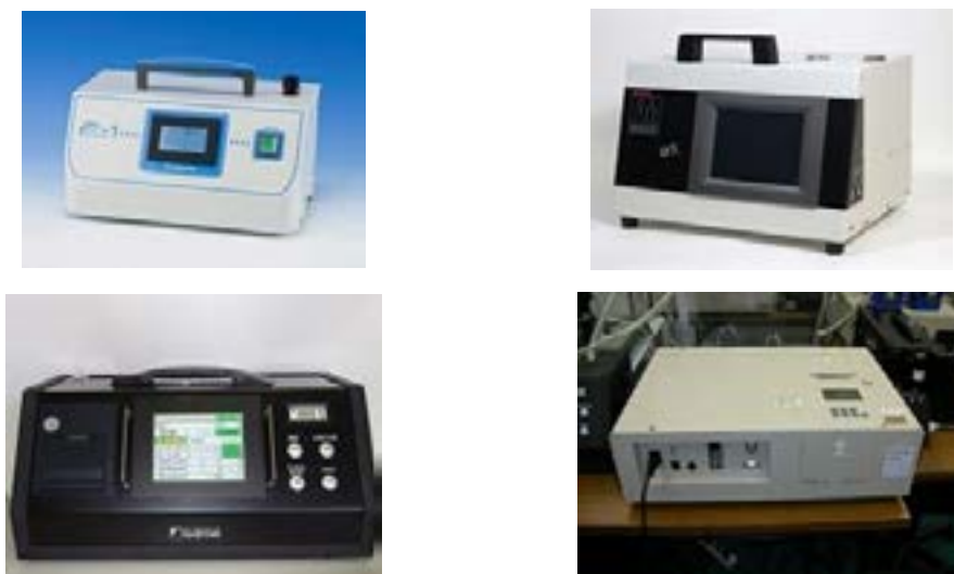
参考図 4.4 繊維状粒子自動計測器の例
