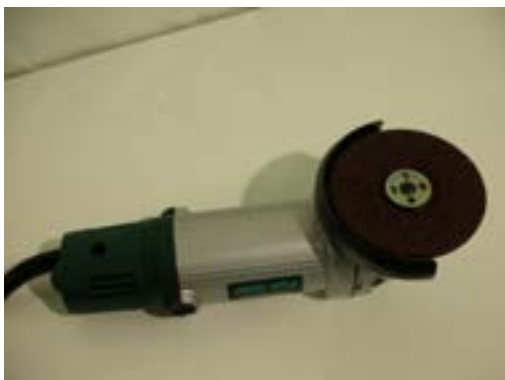
参考写真5.7 工程2 ディスクサンダー (HITATI PDA-100F)
