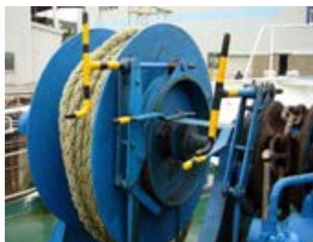
図 2-11 ウインドラスのブレーキライニング
