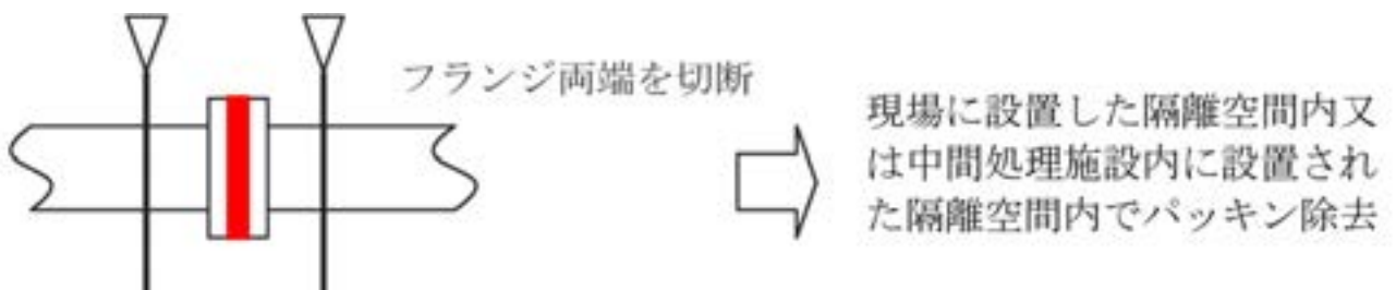
図4.10.10 配管用シートパッキン解体・撤去例
