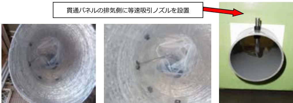
参考図 4.17 等速吸引ノズルを使用した場合の排気ダクト内の測定例
