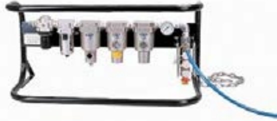
図5.2.9 マスク用空気清浄装置の例 †
