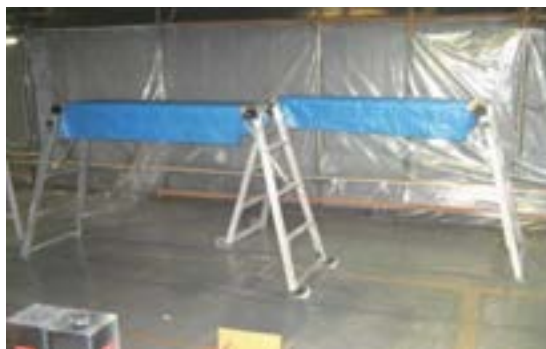
参考図3.33 可搬式作業台の例
