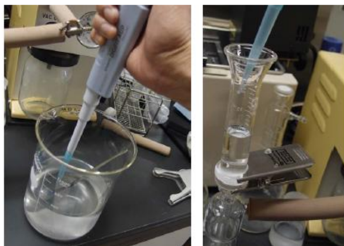
5 図 3.52 ビーカーの懸濁液を攪拌しながら分取して、MCE フィルタに吸引する
