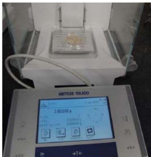
図 3.56 ポリカーボネートろ紙上の懸濁させた成分を秤量する
