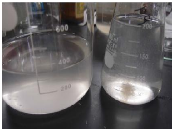
図 3.51 攪拌-静置して上澄みを左のビーカーに移す
