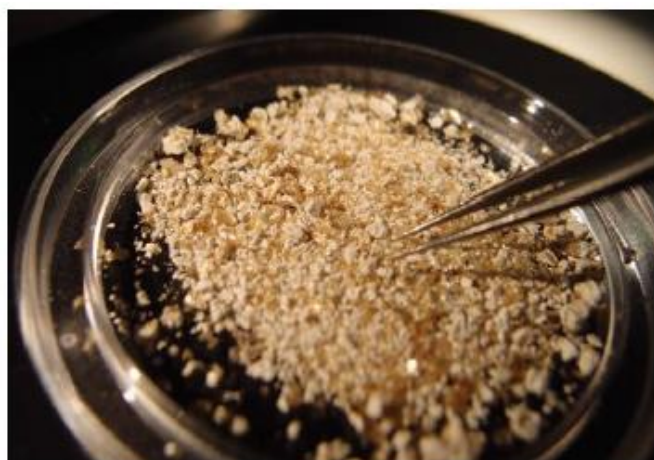
図 3.55 アスベスト繊維をピンセットで取り出す
