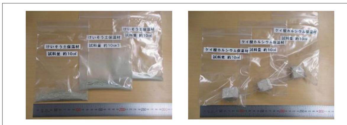
図 3.18 3箇所から採取した試料を袋に収納した例
