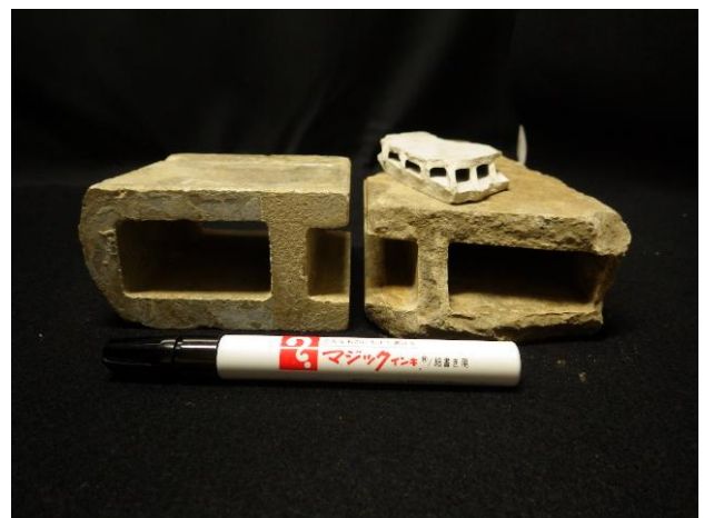
断面写真 中空になっていることが特徴である。
