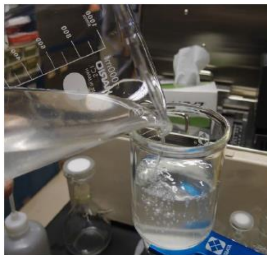
図 3.52 必要枚数の MCE フィルタを作成したら、 残りはポリカーボネートフィルタに吸引ろ過する
