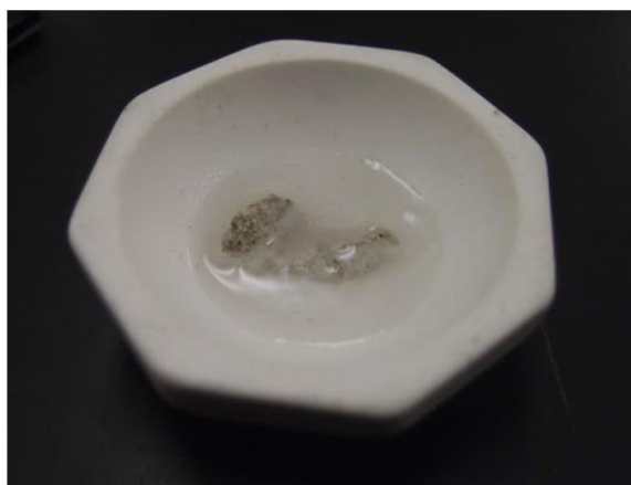
図 3.48 試料をメノウ乳鉢に入れて塩酸を加え、乳棒で崩す
