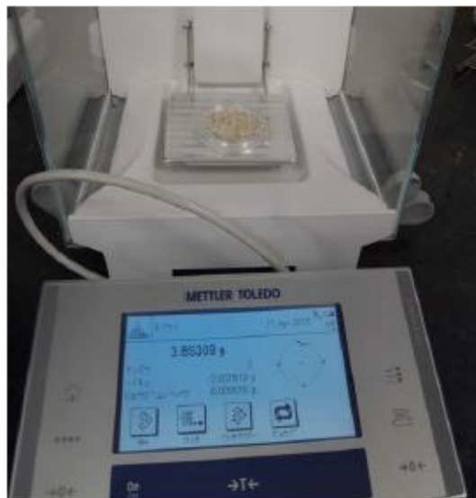
図 3.55 ポリカーボネートろ紙上の懸濁させた成分を秤量する
