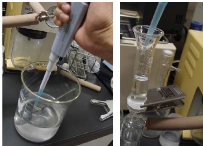
5 図 3.51 ビーカーの懸濁液を攪拌しながら分取して、MCE フィルタに吸引する
