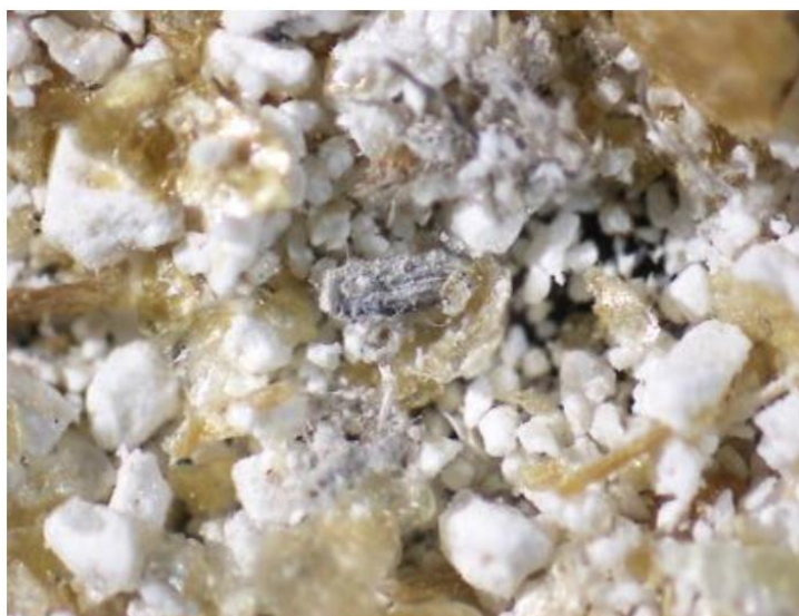
図 3.53 沈降した成分中のアスベスト繊維（中央の繊維束）
