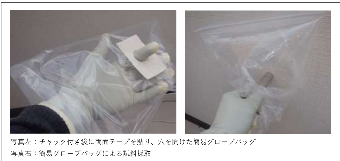
図 3.22 簡易グローブバッグによる試料採取の例
