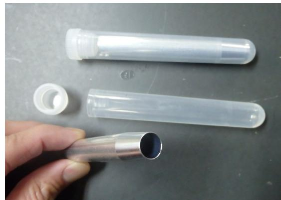
写真左：コルクボーラーは、筒状の先端がギザギザになっており、回転させて採取する。
