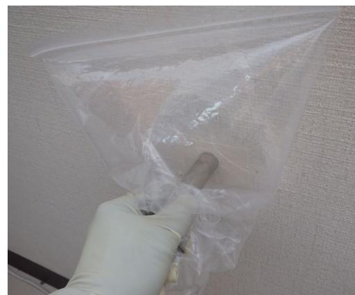
写真左：チャック付き袋に両面テープを貼り、穴を開けた簡易グローブバッグ
