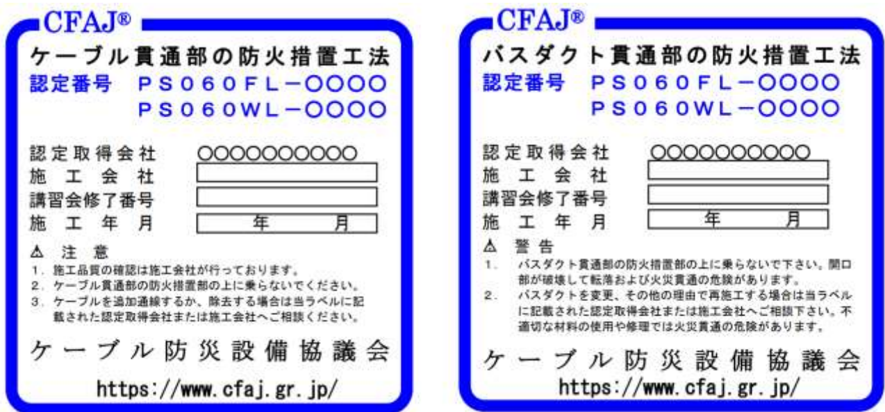
図3.8 工法表示ラベルの例
