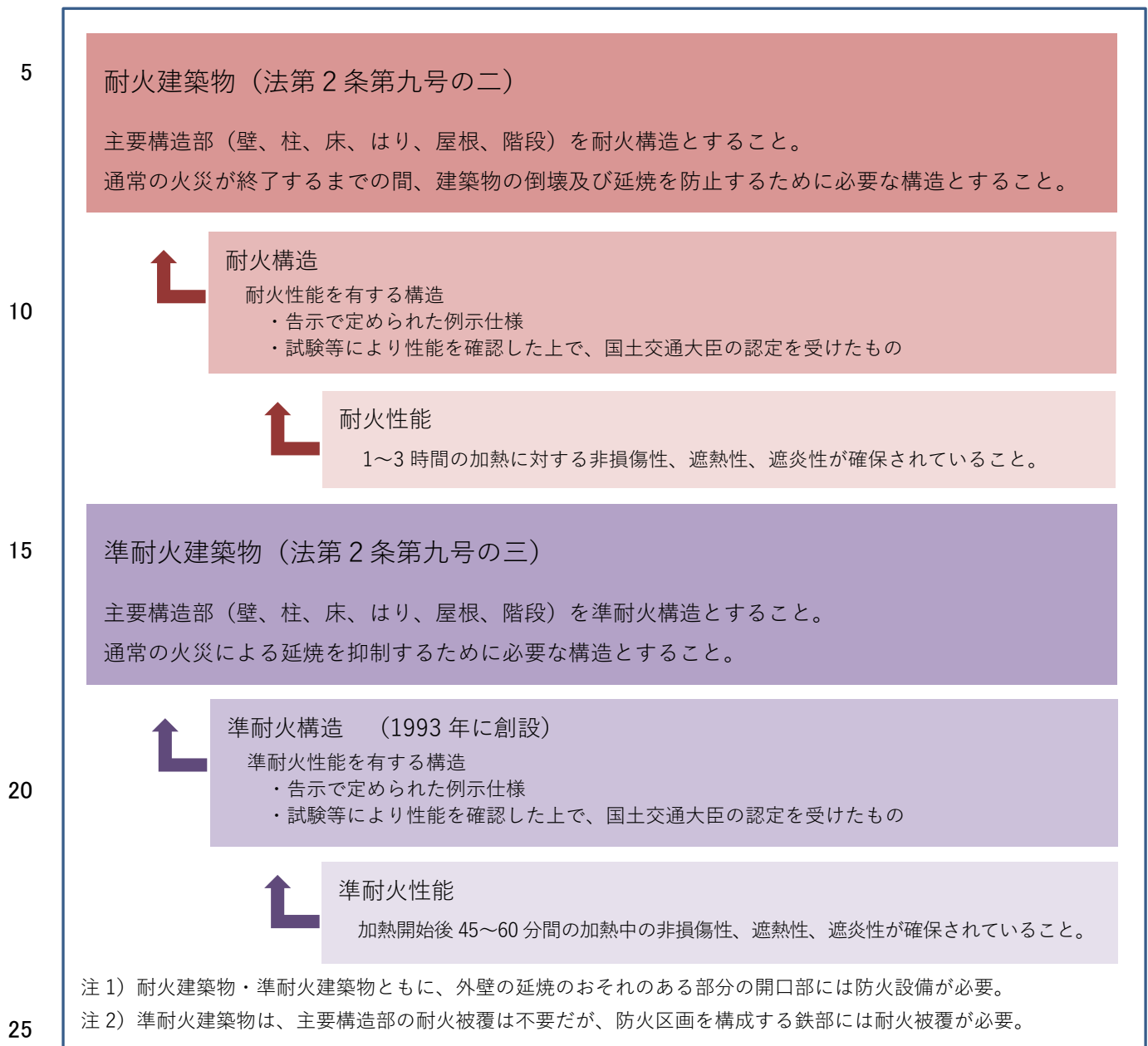
図 2.1 建築基準法における耐火建築物と準耐火建築物の概要
