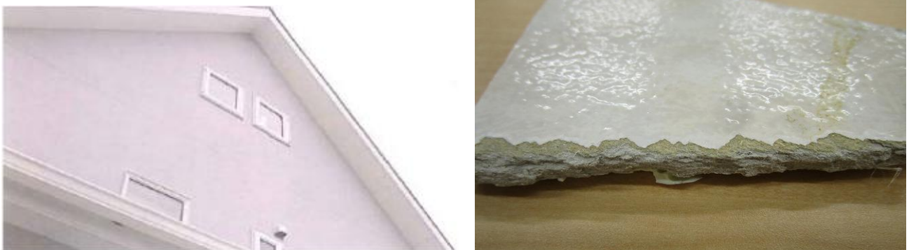
15 図 2.41 石綿含有スラグセッコウ板の施工例（左）と建材の近撮（右）
