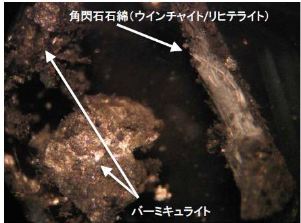
写真4:吹付けパーミキュライト中の角閃石石綿
