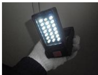
照明 (据置や壁掛けができる LED 照明(両手がフリー)や、保護帽のつば内に取り付けるタイプなど)
