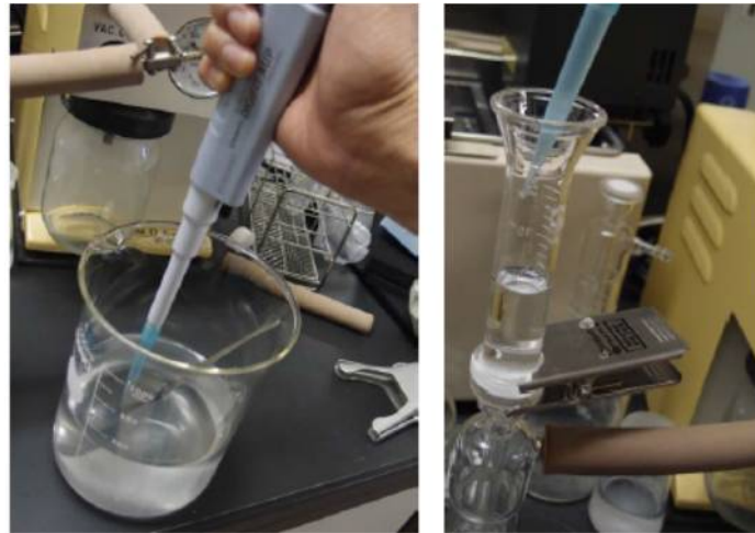
図 3.51 ビーカーの懸濁液を攪拌しながら分取して、MCE フィルタに吸引する
