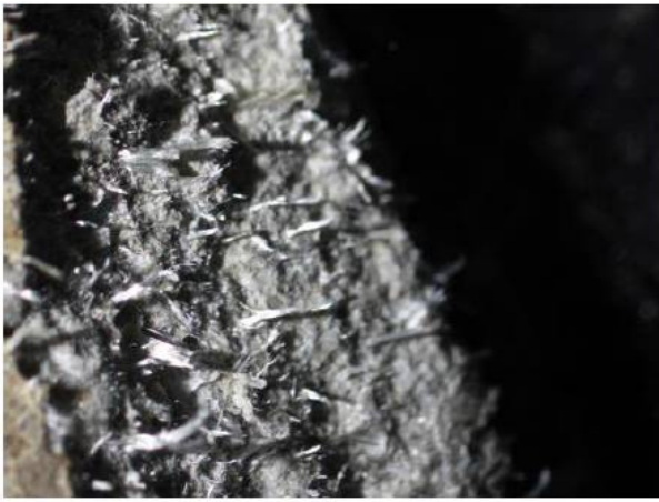
写真1:スレート板中のクリソタイル
