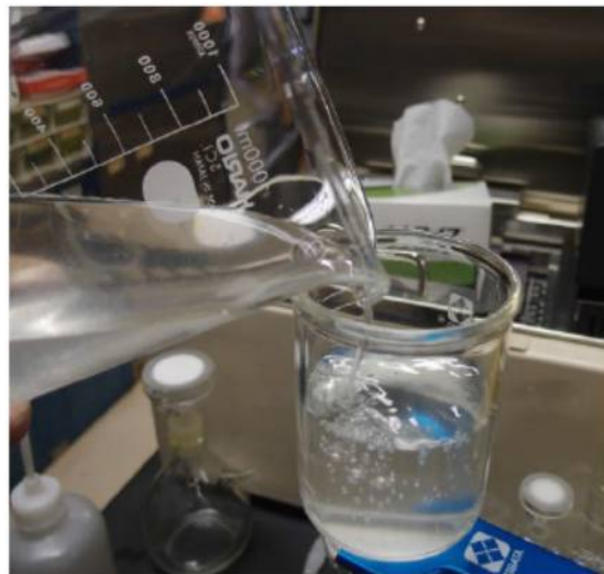
5 図 3.52 必要枚数の MCE フィルタを作成したら、残りはポリカーボネートフィルタに吸引ろ過する
