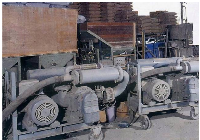
図 2.8 半乾式吹付け施工と機械
