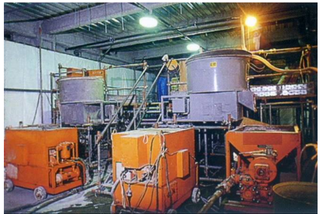
図 2.9 湿式吹付け施工と機械
