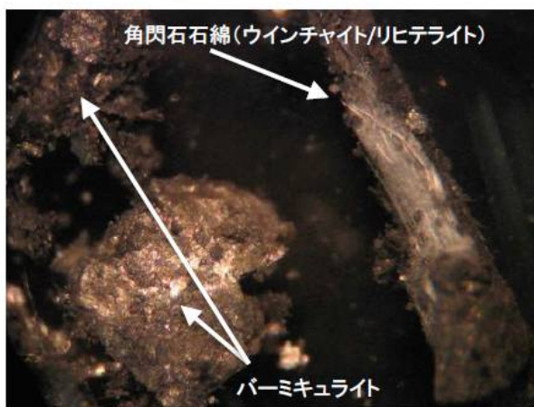
写真4:吹付けパーミキュライト中の角閃石石綿 (ウインチャイト/リヒテライト) パーミキュライト
