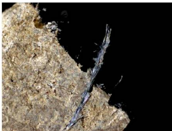
写真2:スレート板中のクロシドライト
