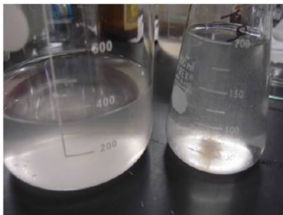
図 3.50 攪拌-静置して上澄みを左のビーカーに移す
