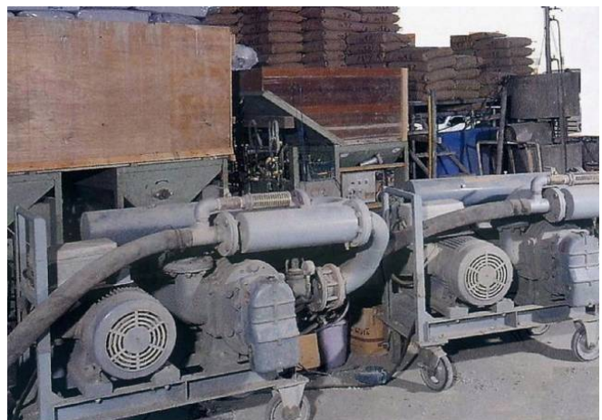
図 2.8 半乾式吹付け施工と機械
