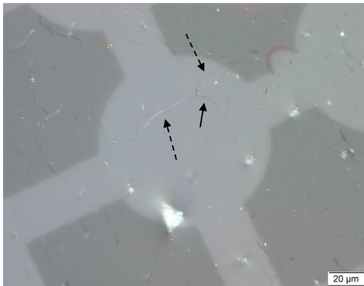
(ii) 直交ニコルでセナルモンコンペンセーターを挿入 セナルモンコンペンセーターのダイヤルを時計回りに回転。 伸長性：正では、右上がりの繊維は背景より明るくなり、左上がりの繊維は暗くなる（矢印の繊維）。右上がりの繊維では位相差像で見えていない部分が確認出来ている（点線矢印の位置） ※11 。
